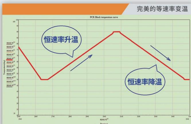
在实际应用中，并非所有的PCR实验都要求变温速率越快越好。有的检测试剂对PCR的升温或降温速率有一定的要求。尤其是有些临床试剂，如耳聋基因检测试剂盒，要求保持恒定的升温速率或降温速率，以确保PCR反应的结果。经过长期的技术积累和算法优化，ETC811提供了近乎完美的线性控温曲线。
